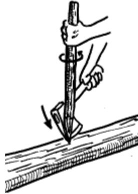
Uma estaca deve ter a parte de trás ligeiramente desbastada, como na figura acima, para evitar que, ao bater na nela, se desfaça.
