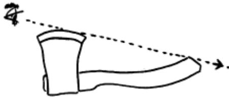
Num machado bem alinhado, o gume da lâmina deve estar em linha com a ponta do cabo.
